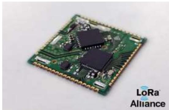
LoRaWAN™/BLE 対応コンボモジュール
